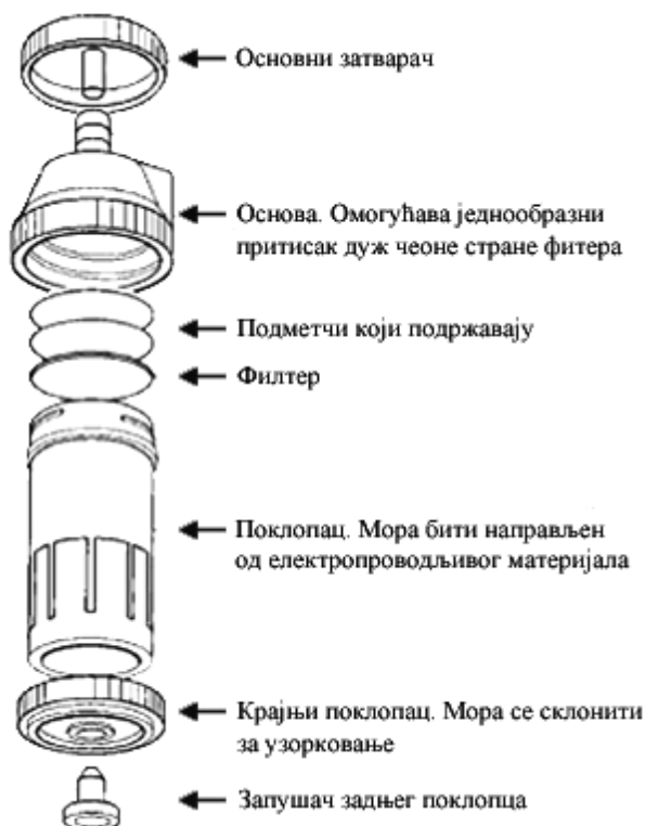
Слика 1. Приказ раздвојеног личног узоркивача
